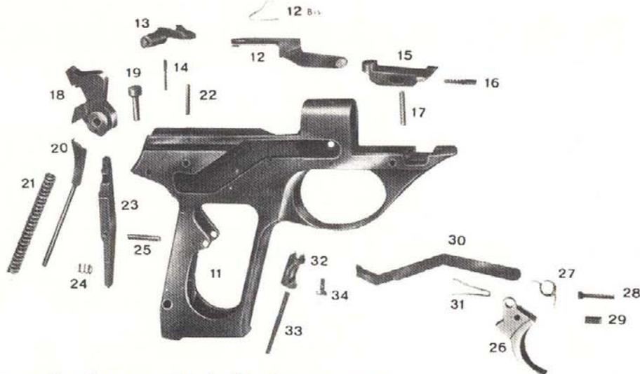
**Mécanismes de chargement et détente, carcasse.**
